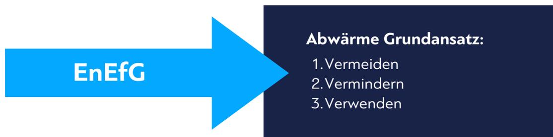
Abbildung 2: Abwärme-Grundsatz des Energieeffizienzgesetzes
